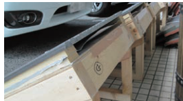
遮熱シート効果の簡易実験。二重化屋根の遮熱シート「有り・無し」の原寸模型を日向に置き、2番目の下地の温度を比較。遮熱シート有りは無しに比べ3℃低い。
